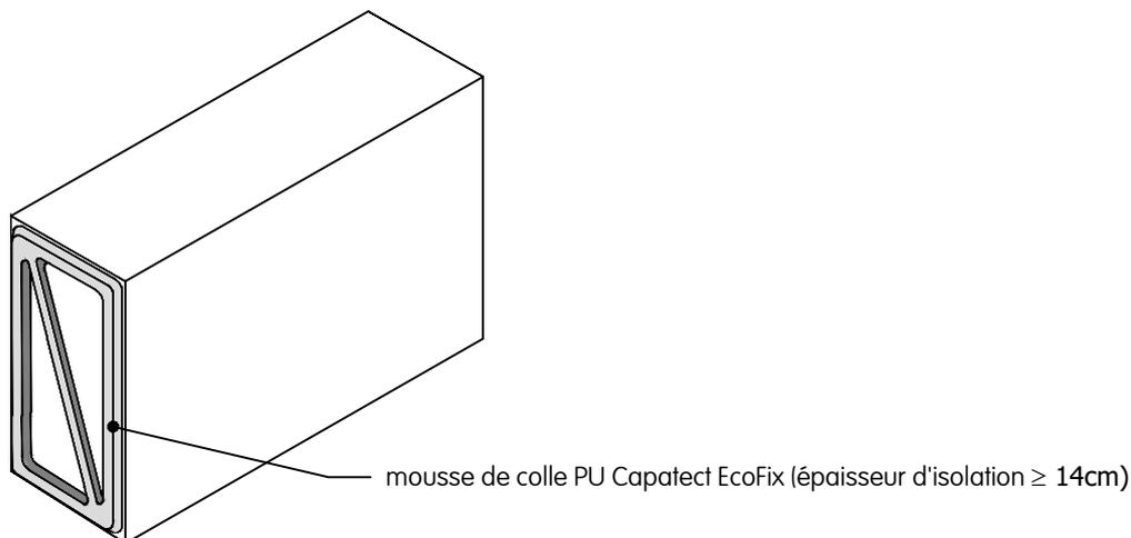
**Raccord isolation thermique | coin extérieur | coupe horizontale**
