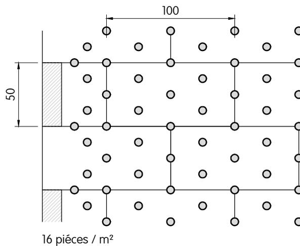
Note: en cas de montage encastré Capatect Universaldübel-tool et Capatect Universaldübel-Rondelle Eps
