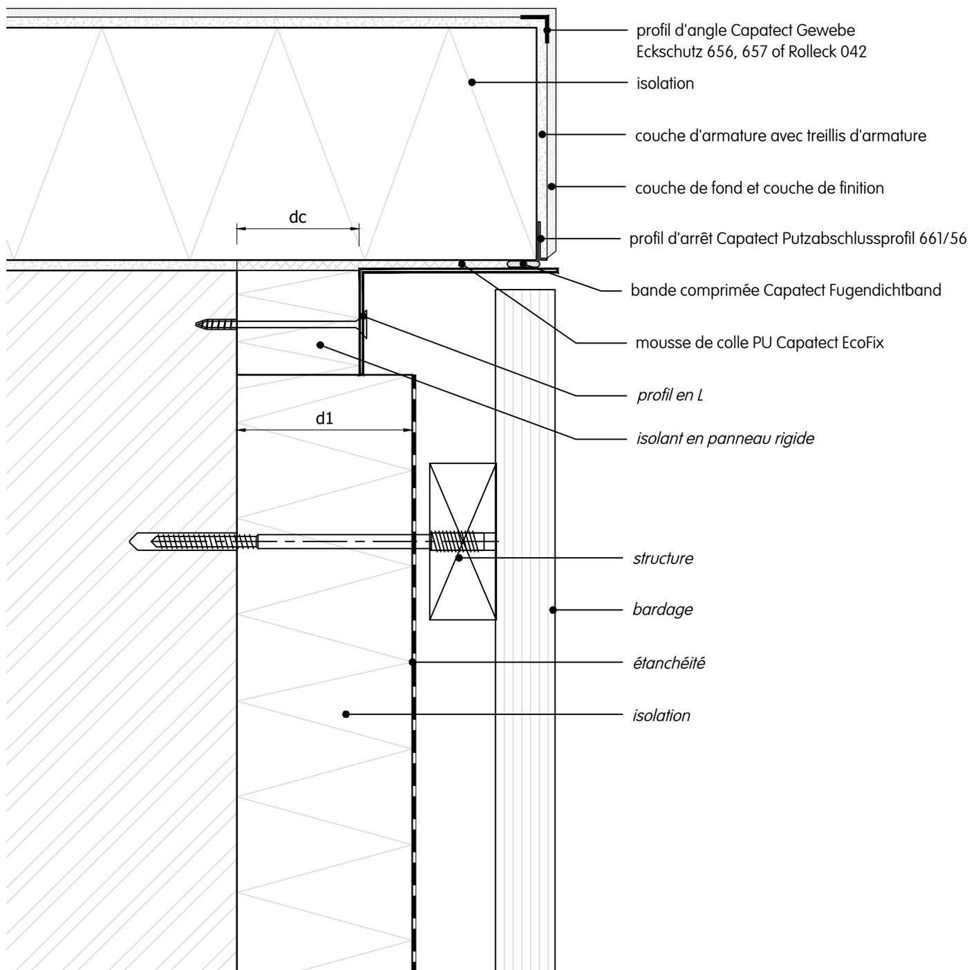
$$dc \geq \frac{\text{épaisseur min. (d1 of d2)}}{2}$$
