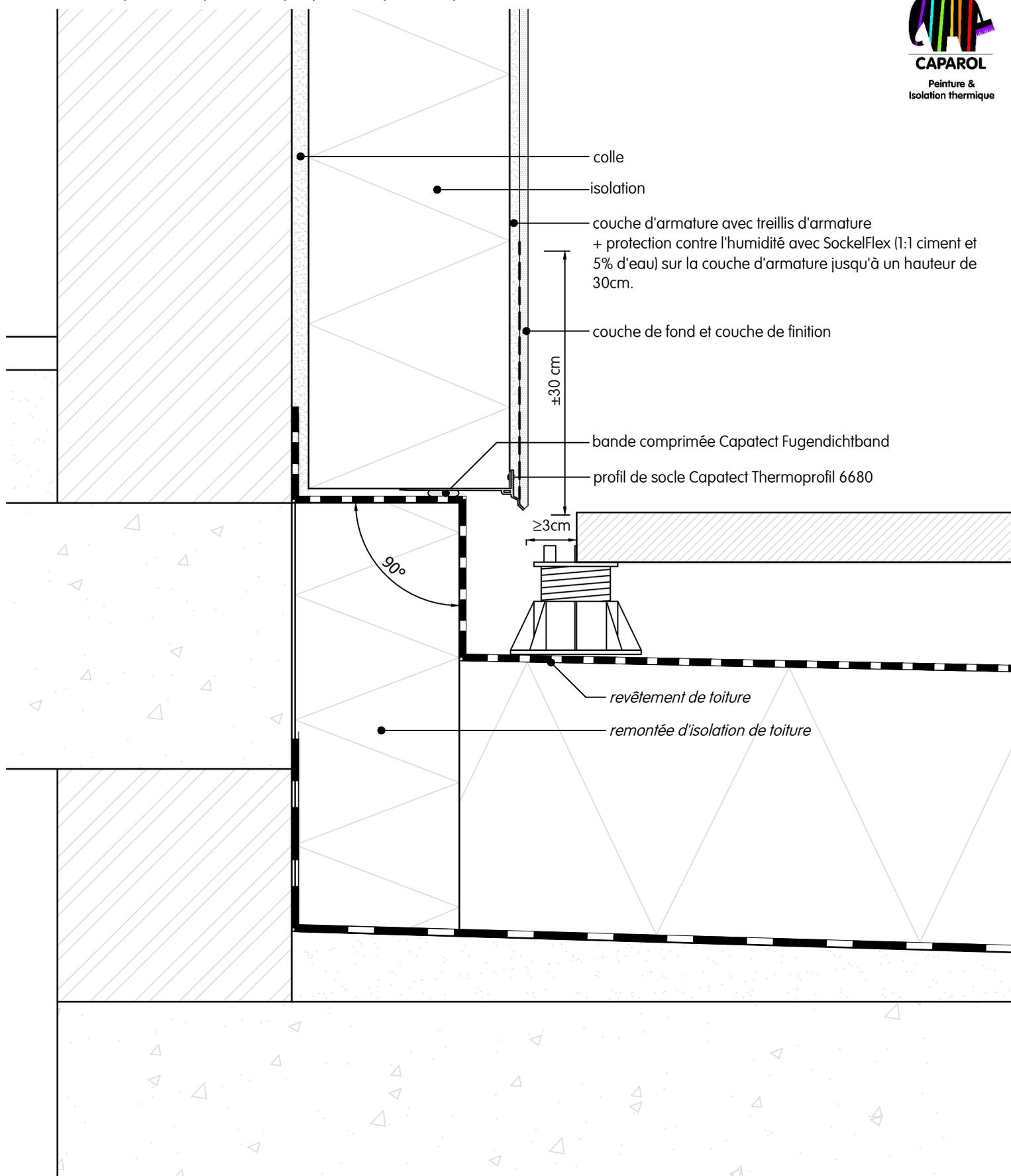
Le remontée d'étanchéité en l'isolation de toiture sous-jacente à l'isolant Capatect doit être plat et à angle droit !
