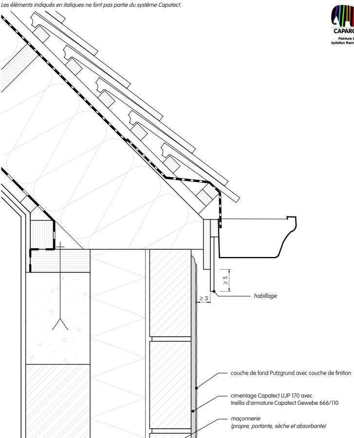
Façade cimentée | raccord toiture | pied de toiture | coupe verticale
