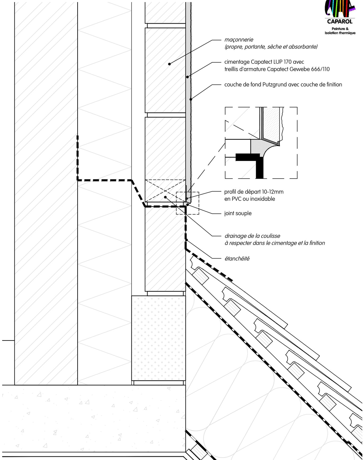
**Façade cimentée | raccord toiture | jonction d'un versant de toiture contre un mur butée |
