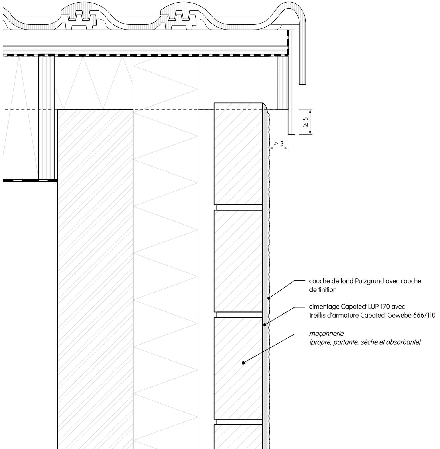
**Façade cimentée | raccord toiture | raccord avec tuile de rive | Coupe verticale**
