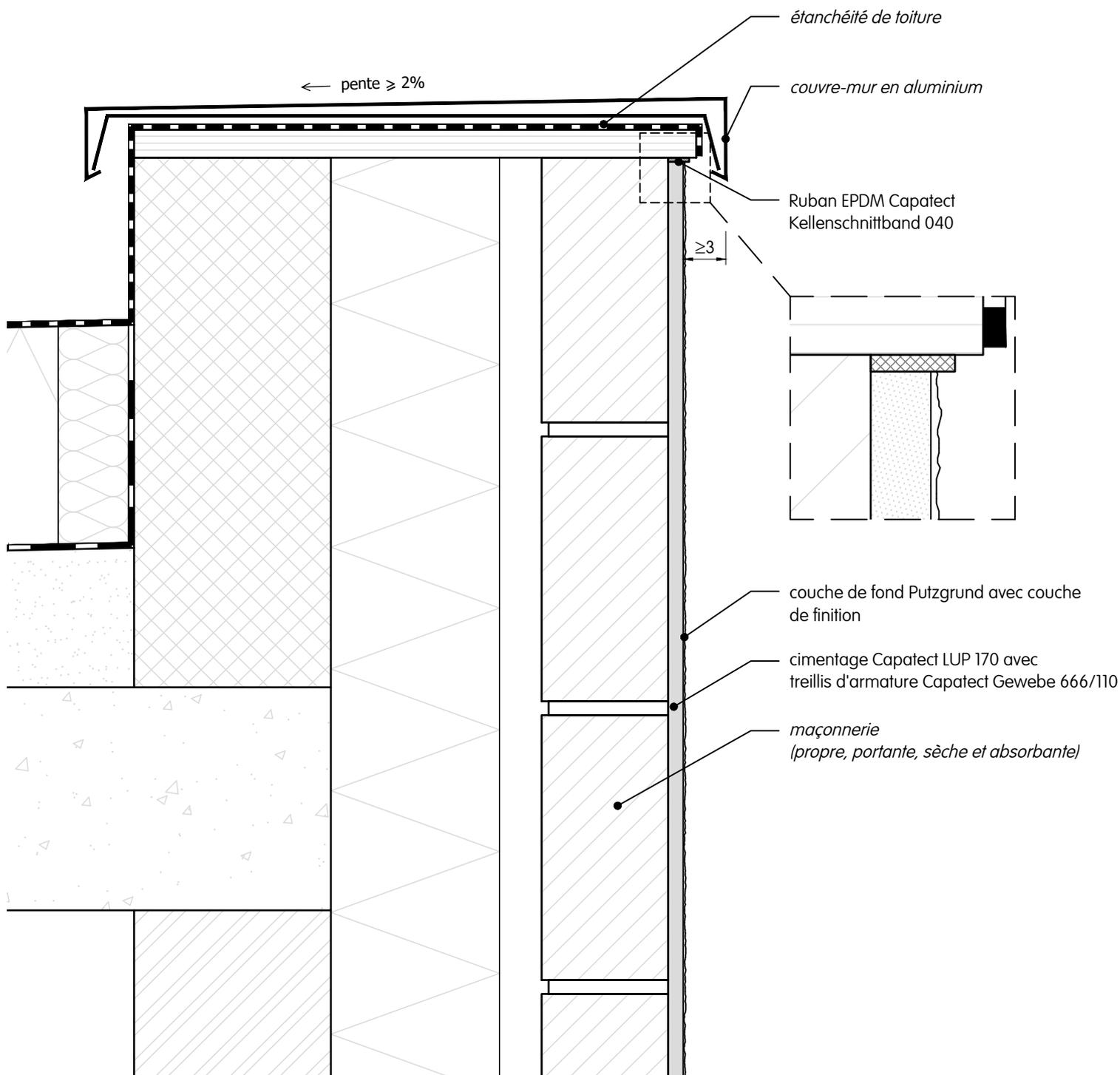
Façade cimentée | raccord toiture | raccord avec couvre-mur en aluminium | coupe verticale
