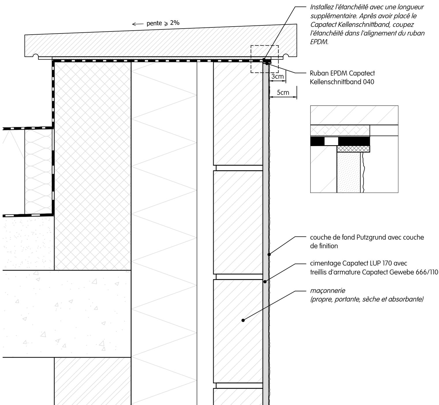
**Façade cimentée | raccord toiture | raccord avec couvre-mur en pierre | coupe verticale**
