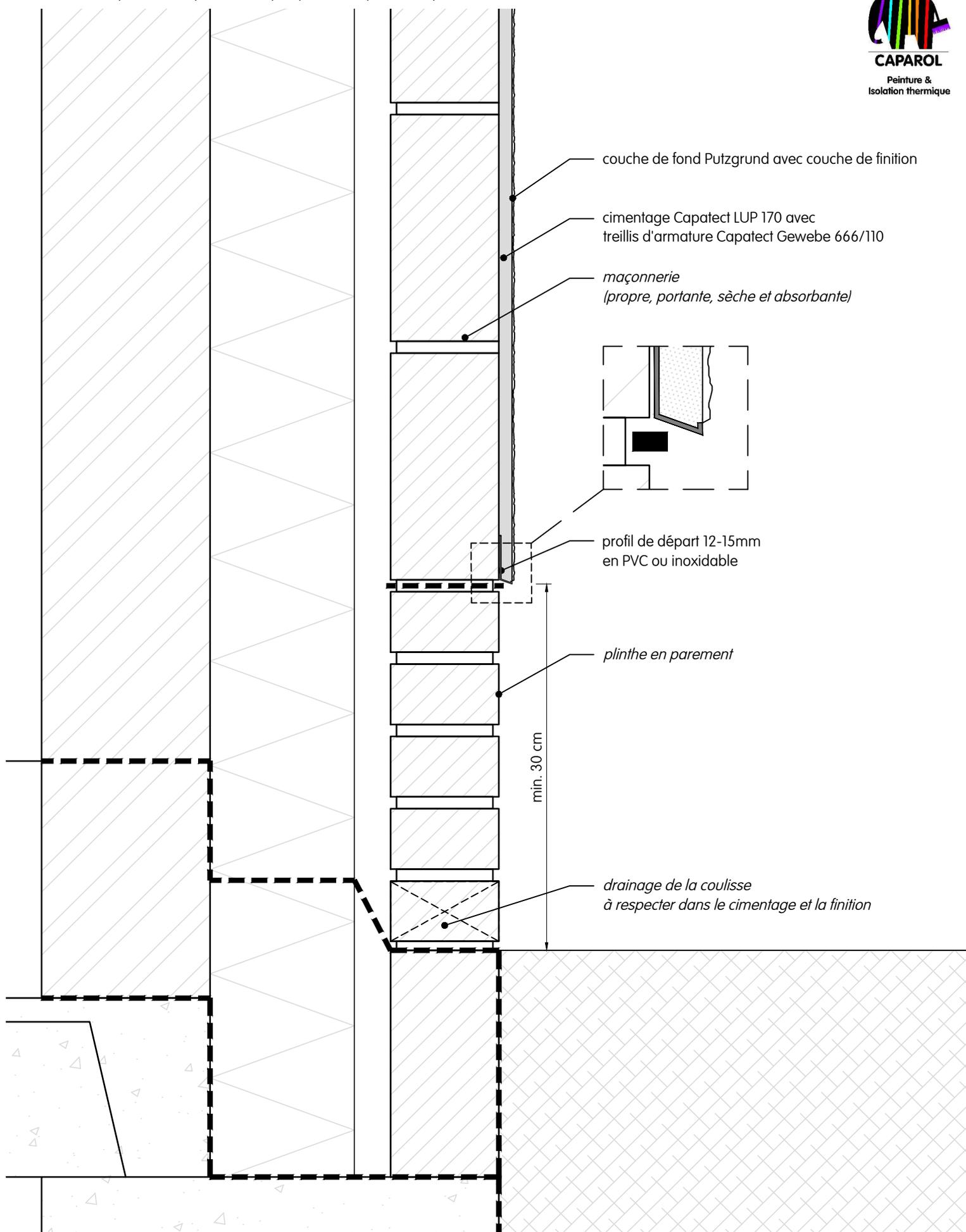
**Façade cimentée | pied du mur en parement | coupe verticale**
