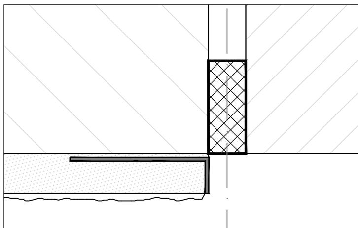
Façade cimentée | joint de construction | mur mitoyen | coupe horizontale
