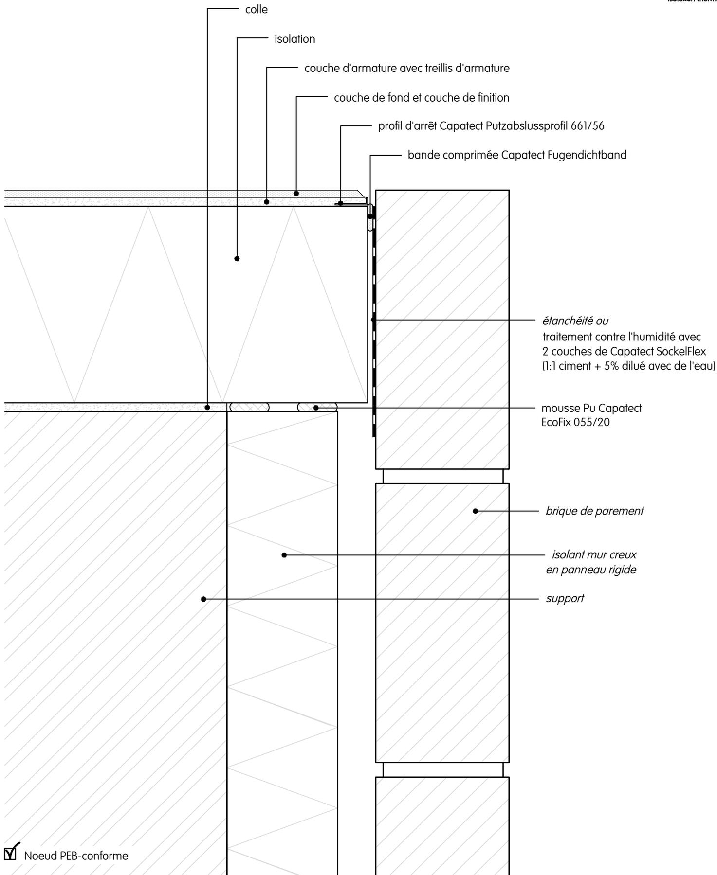
**Raccord brique de parement | coin extérieure | coupe horizontale**
