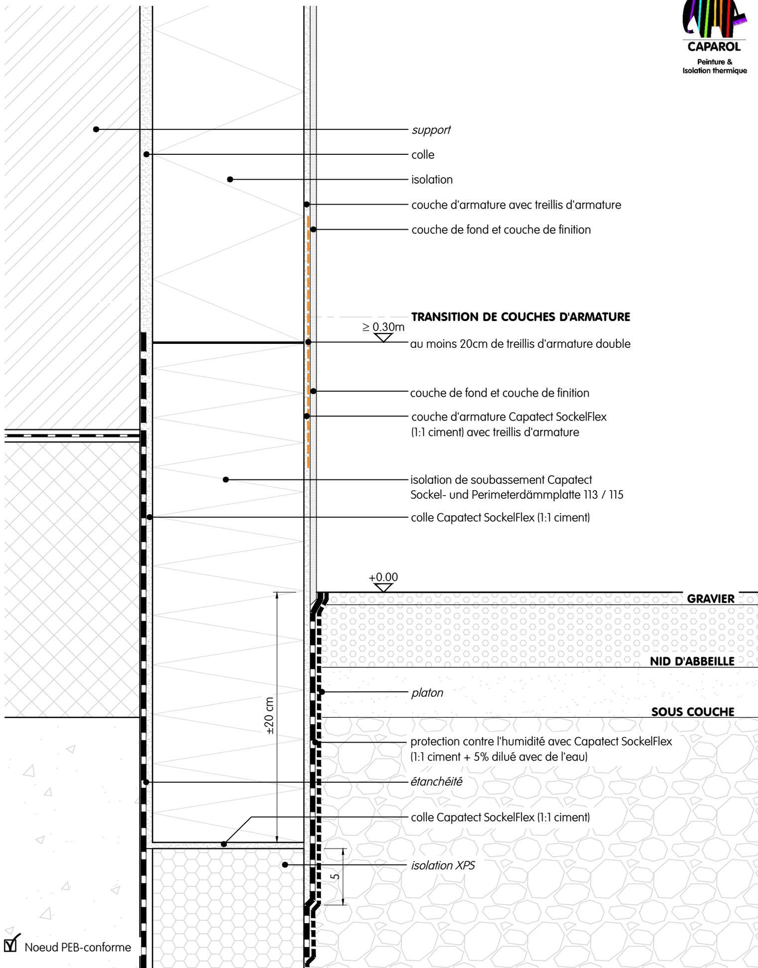
**Raccord isolation thermique avec Capatect System Peri-M | dans le même plan | connexion avec l'isolation des murs de la cave | gravier | coupe verticale**
