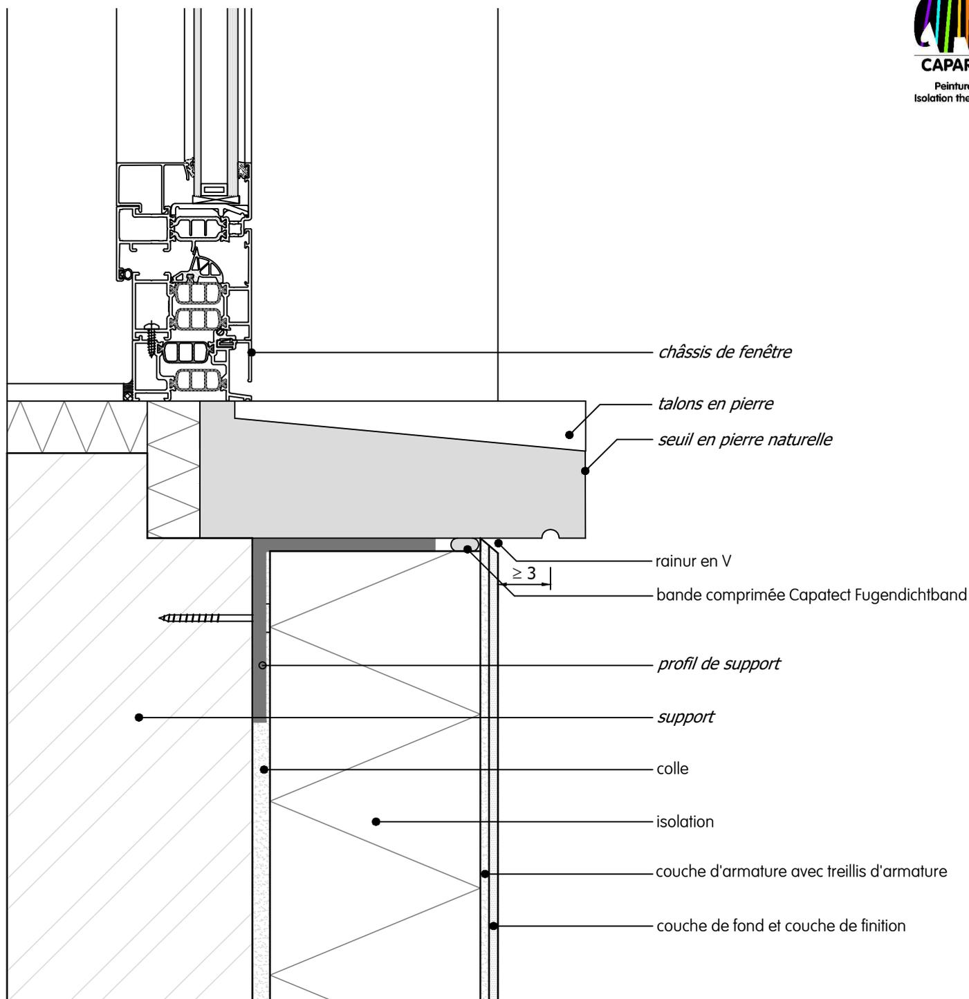
Si le seuil est constitué de plusieurs parties, des précautions doivent être prises pour éviter l'infiltration d'eau par le joint. Cela peut se faire en fermant le joint avec un profil isigo (par des tiers).
