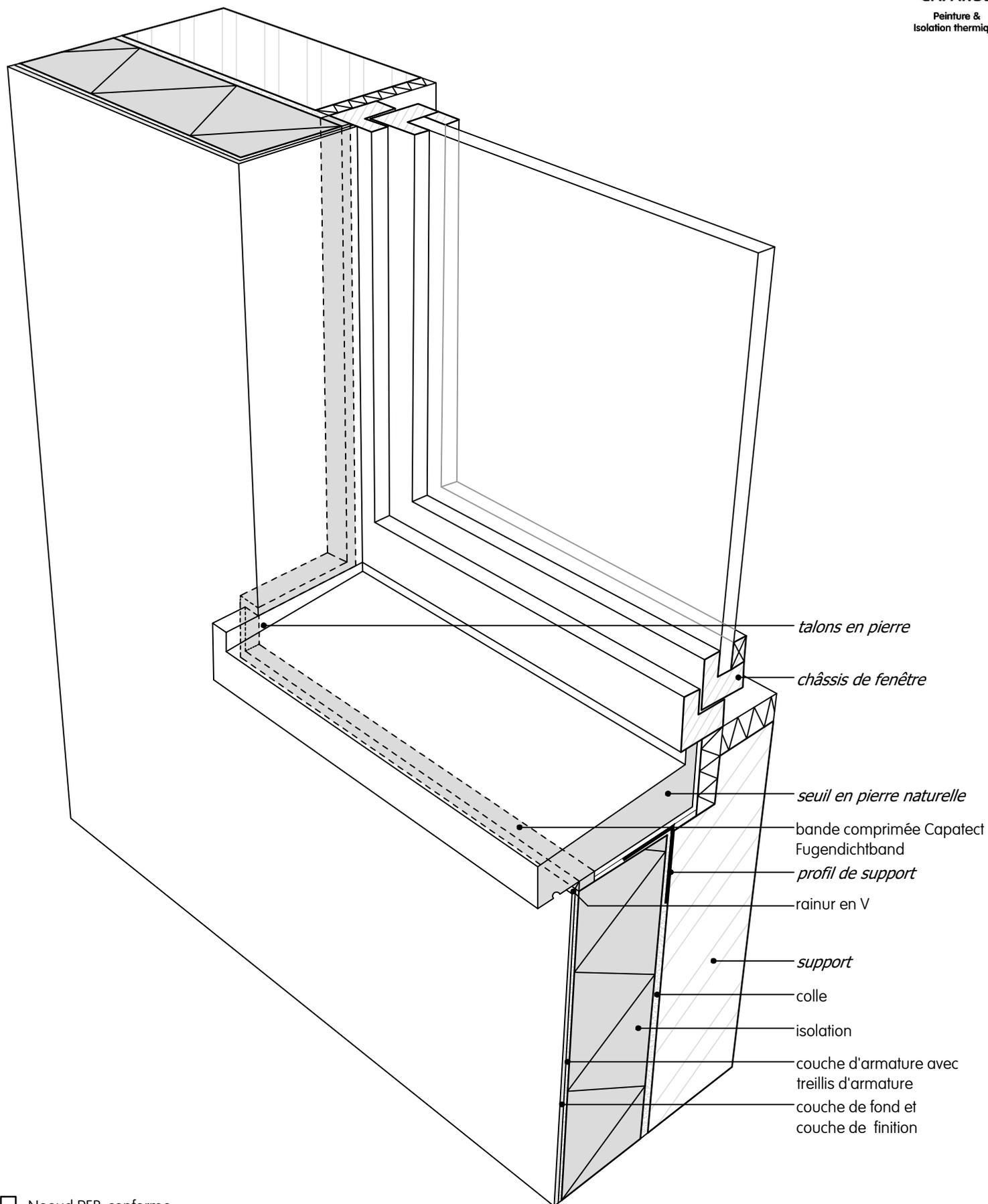
**Raccord fenêtre | fenêtre dans le même plan | seuil en pierre naturelle | 3D**
