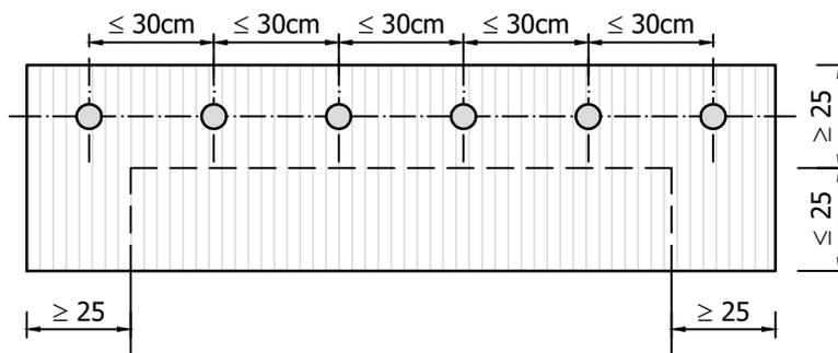
**Raccord fenêtre | caisson à volet non stable | panneau support d'enduit avec profil de raccordement | coupe verticale**
